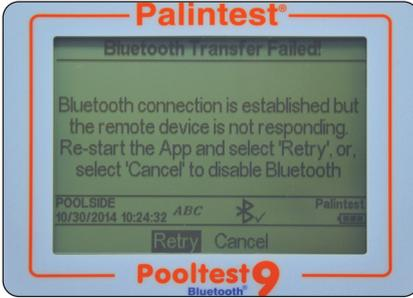
Le Pooltest 9 Bluetooth ne reçoit pas de réponse de l'application Palintest Aqua Pal mais le dispositif portable est connecté. Ce message s'affichera 10 s après le début de la transmission d'un résultat lorsqu'aucune réponse valide n'est reçue.
