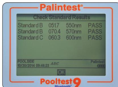
Si le Mode Vérification Standard rapporte un échec, voir l'Annexe 2 Dépannage pour des conseils ou contactez votre fournisseur Palintest local.
