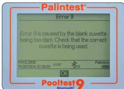
Vérifiez que la cuvette du blanc est utilisée et non la cuvette de l'échantillon plus le réactif. La couleur de l'échantillon peut être réduite par dilution avec de l'eau propre, la dilution sélectionnée doit prendre en compte la concentration attendue du paramètre testé. Les résultats du blanc sont stockés dans la mémoire temporaire du Pooltest 9 Bluetooth et seront utilisés pour tous les tests ultérieurs jusqu'à ce que :
