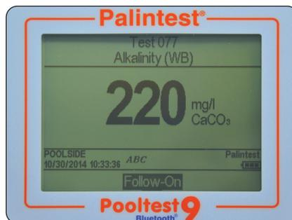
Pour accéder au test complémentaire, sélectionnez Complément et appuyez sur OK. La méthode suivante est automatiquement chargée et utilisée de la manière usuelle.
