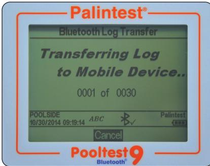
Si la connexion est perdue, le Pooltest 9 Bluetooth demandera la re-connexion. Si la connexion n'est pas nécessaire ou possible, appuyez sur Quitter pour désactiver Bluetooth et annuler le transfert du journal. Le message "Transfert du journal terminé" s'affiche lorsque tous les points de données ont été chargés. Appuyez sur OK pour revenir au menu précédent.
