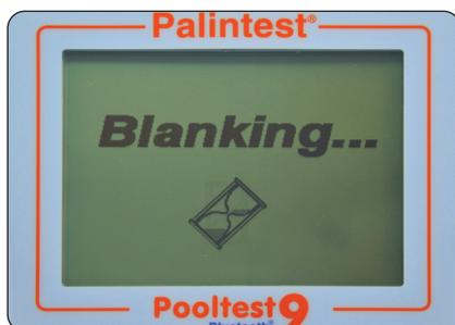
Le Pooltest 9 Bluetooth déterminera l'absorbance due à la couleur de l'échantillon à toutes les longueurs d'onde simultanément et la stockera dans la mémoire temporaire pour l'analyse.
