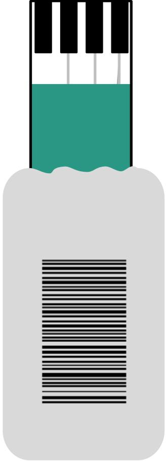
Gardez la moitié inférieure du film lors de l'insertion du capteur dans l'instrument
