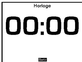
Saisir le temps désiré en minutes et secondes avec les boutons numériques (maximum 29 minutes 59 secondes), puis appuyer [OK]. Utiliser les boutons ← et → pour repositionner le curseur, et ressaisir le temps s'il n'est pas saisi correctement.
