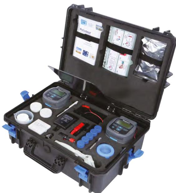
Pouvant effectuer les tests microbiologiques et physico-chimiques, le Potalab®+ est le laboratoire portable le plus évolué des kits Wagtech.
