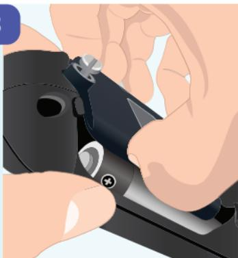
Le couvercle se soulèvera et, si nécessaire, la vis pourra être davantage desserrée afin que le couvercle puisse être complètement retiré.
