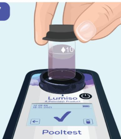
Préparez un échantillon de 10 ml en ajoutant des réactifs conformément aux instructions de test. Placez ce tube à échantillon dans le porte-tube.
