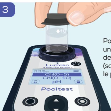
Pour faire le blanc placez un tube à essai contenant de l'eau de piscine ou de spa (sans pastilles de test) dans le porte-tube.
