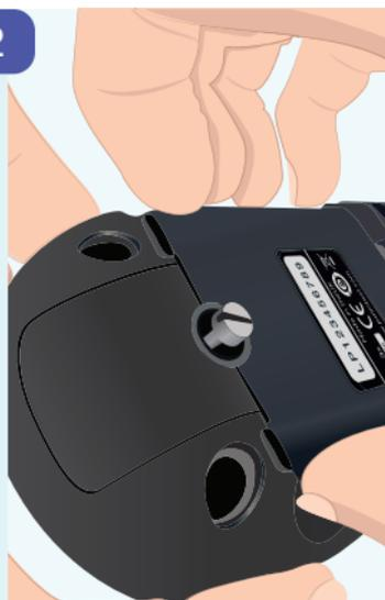
Le joint étanche intégré dans le couvercle du compartiment à pile pousse à utiliser une force de traction ferme pour le retirer.
