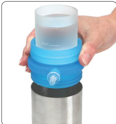
**REMARQUE:** Si l'échantillon ne doit pas être recueilli dans la partie récipient d'échantillonnage de l'unité de filtration à membrane, l'entonnoir du filtre/la base peuvent être immédiatement insérés en position dans le récipient d'échantillonnage.
