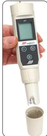
Plongez la sonde dans 2 à 3 cm de solution tampon et remuez/tournez doucement. Le capuchon protecteur peut être utilisé pour porter le tampon.
