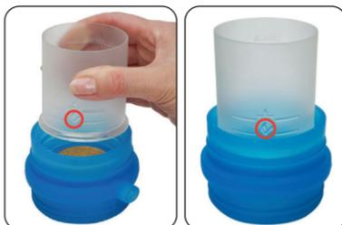
Une fois la flamme pratiquement éteinte, intervertissez l'entonnoir du filtre et les composants de la base en caoutchouc de silicone de l'UFM et insérez-le dans le récipient d'échantillonnage comme illustré ci-dessous.
