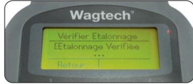
La fonction « **Vérification Etalonnage** » fournit une vérification électronique simple que les deux thermistances relèvent la même température avec une marge de tolérance spécifiée. Si la comparaison est hors plage, s'affichera le message **Erreur 107: Validation Temp.**
